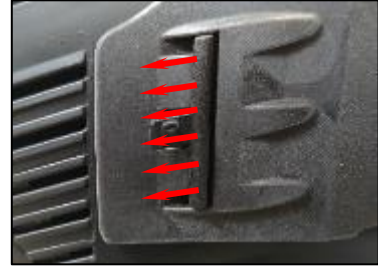
Fig. 2 – Retrait du verrou de la lentille
