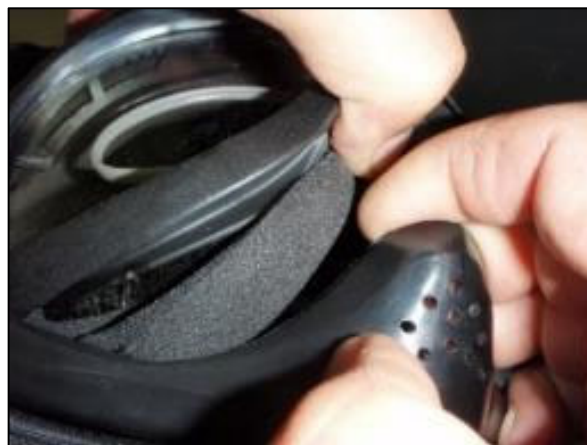
Fig. 14a – Section du nez de la coquille en plastique du Casque Protecteur FX® 9003
