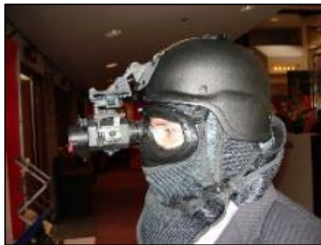
Fig. 3 – Casque de protection FX® 9004 muni de lunettes de vision nocturne
