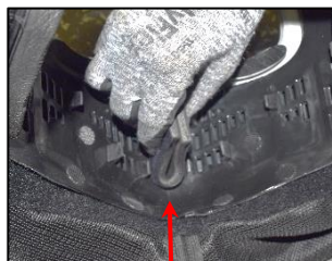
Fig. 61 – Marque centrale sur la coquille à la hauteur du menton
