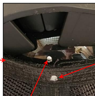
Fig. 36 – point en relief sur la coquille du casque de protection FX® 9004
