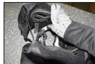
Fig. 17b - Insertion du côté droit de la lunette assemblée
