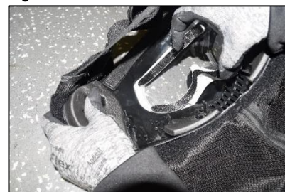
Fig. 44 – Coquille du casque de protection FX® 9004, côté gauche. Insertion de la lunette assemblée.
