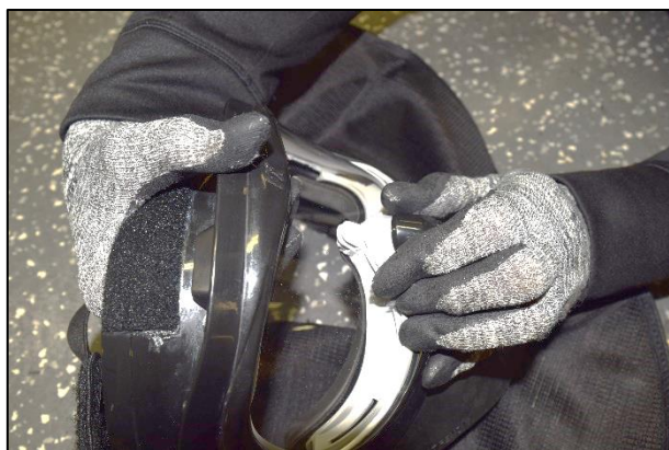
Fig. 14 - Section du nez de la coquille en plastique du casque de protection FX® 9004
