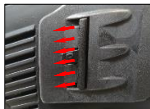
Fig. 9 – Retrait du verrou de la lentille
