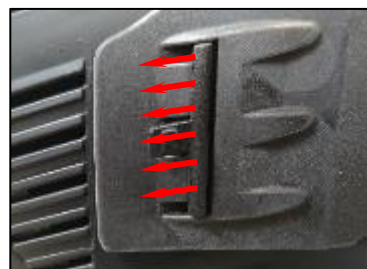
Fig. 20 – Verrou de la lentille - retrait
