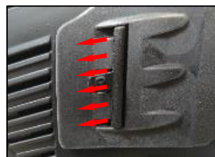
Fig. 9 – Retrait du verrou de la lentille
