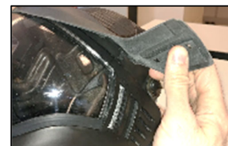
Fig. 10A – Déflecteur en caoutchouc
