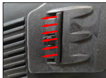
Fig. 20 – Verrou de la lentille - retrait
