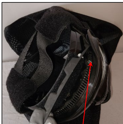
Fig. 73 – Dernier orifice de ventilation
