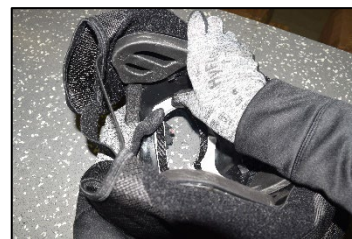
Fig. 44b - Insertion du côté droit de la lunette FX® 9003/9004
