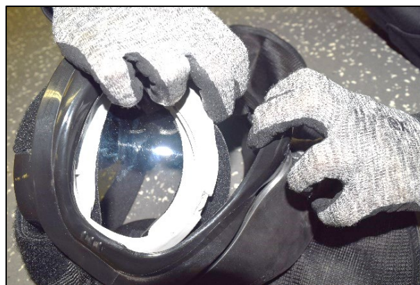
Fig. 14a - Section du nez de la coquille en plastique du casque de protection FX® 9004
