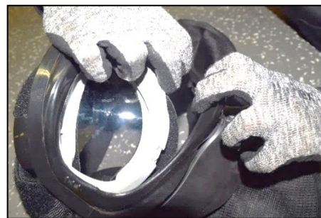
Fig. 42a - Section du nez de la coquille en plastique du casque de protection FX® 9004
