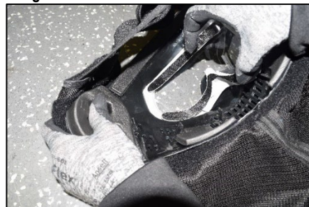
Fig. 16 – Coquille du casque de protection FX® 9004 côté gauche, insertion de la lunette assemblée
